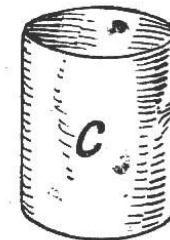
MORCEAU DE CHAMBRE À AIR QUI FAIT UNE BONNE LIASON DU CORNET ET DU TUBE.
