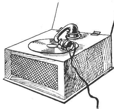
HAUT PARLEUR CONSTITUÉ PAR UN ÉCOUTEUR MONTÉ SUR UN BRAS DE PHONOGRAPHE.
